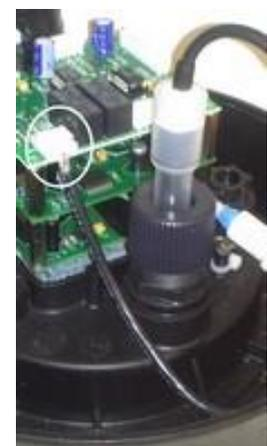
Figura 47 - Conexión de la sonda
