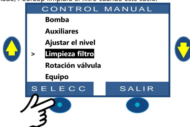
A partir de este momento, PoolCOP controla automáticamente la bomba y el filtro para efectuar un lavado y un enjuague, en función de los parámetros programados. La pantalla mostrará la evolución del ciclo y las presiones durante la limpieza del filtro. Una vez terminado el ciclo, el sistema vuelve a un funcionamiento normal.
