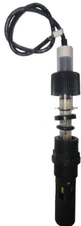
Figura 45 - Sonda y cámara de análisis
