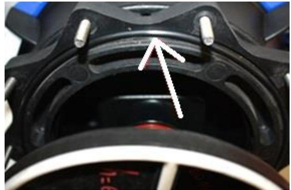
Figura 8 - Junta tórica válvula 2,0"
