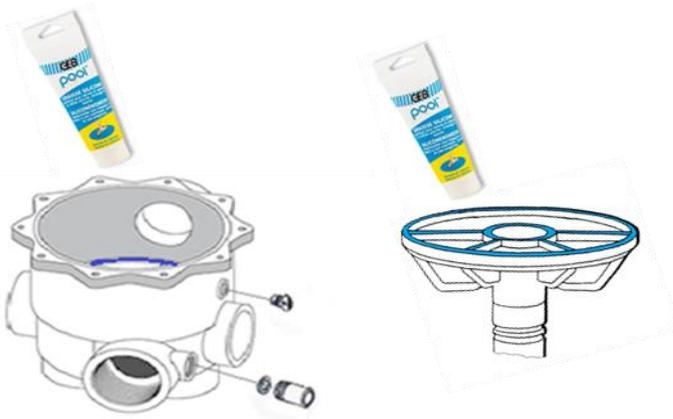
Figura 9 – Lubricación de la junta y la válvula
