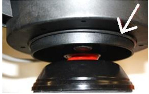
Figura 7 - Junta tórica válvula de 1,5"
